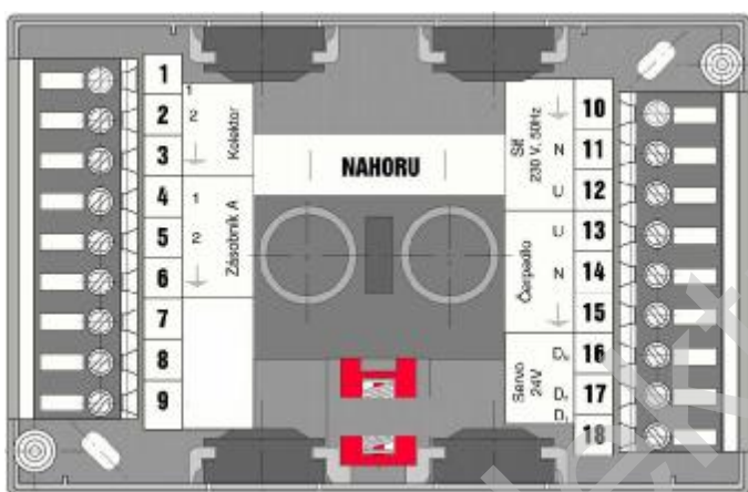
Obr. 5 – Schéma zapojenia svorkovnice regulátora SOLARIS RRT 05.1
